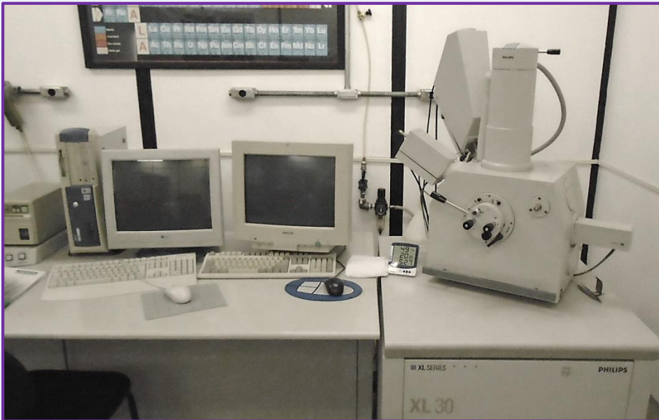
Microscópio Eletrônico de Varredura com Espectrômetro de Energia Dispersiva acoplado (EDS) Filamento de Tungstênio
